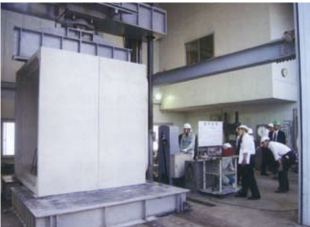
水密試験状況(継手部の確認)
