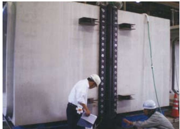
載荷試験状況(本体部の確認)
