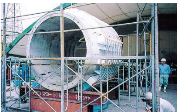
ノンブリーシング粘性型グラウト材を用いて片押し注入で完全に充填できることを確認
