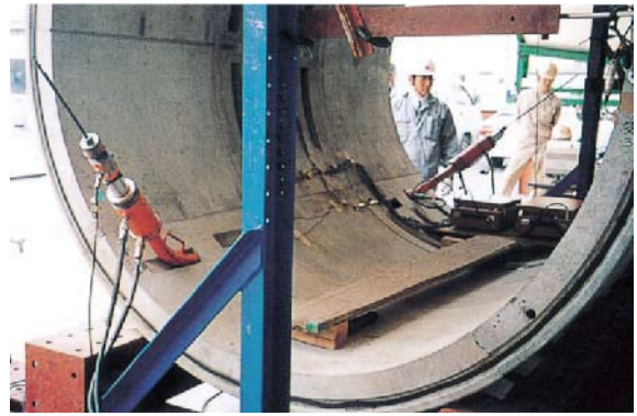
トンネル縦断方向のプレストレスを確認
