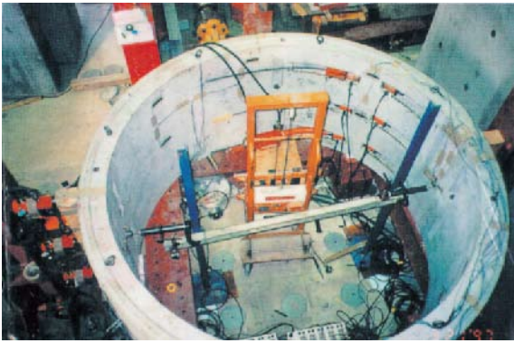
プレストレスとリング剛性および耐力を確認
