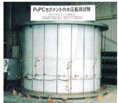
内水圧作用時の止水性および構造の安定性を確認
