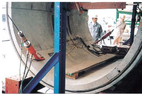
トンネル縦断方向のプレストレスを確認
